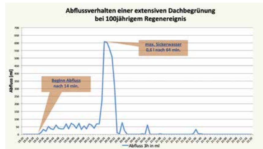
Sickerwasserabfluss einer extensiven Dachbegrünung bei einem 100-jährigen Regenereignis
