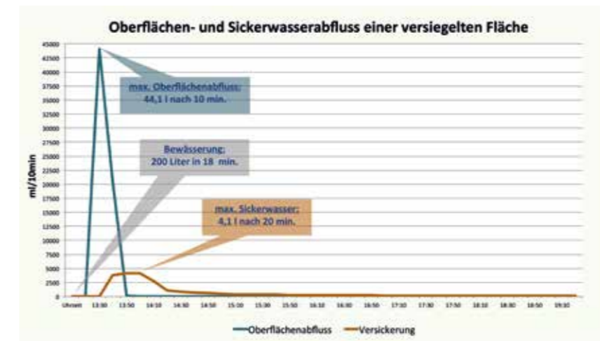
Oberflächen- und Sickerwasserabfluss einer versiegelten Fläche mit 15 m 2 bei einer Messberegnung von 200 l in 30 Minuten
