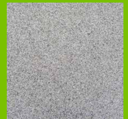
Gebundene Edelsplittbefestigung mit vollflächiger Versickerung
