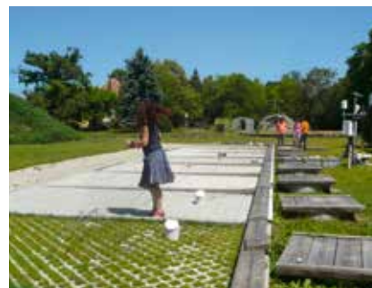
Versuchsanlage versickerungsfähige Oberflächen
